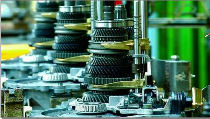
Ligne d'assemblage des boîtes de vitesse
